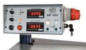
2 indicatori digitali degli spessori inferiore e superiore regolabili in modo indipendente 2 digital display of upper and lower cutting thickness adjustable separately
