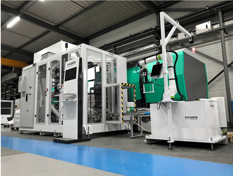
Vollautomatisierte Spritzgießzelle rund um einen hybriden Allrounder 720 H in Packaging-Ausführung.
